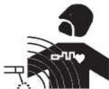
Электрический ток, проходящий через любой проводник, вызывает локальные электромагнитные поля (EMF). Сварочный ток вызывает электромагнитное поле вокруг сварочной цепи и сварочного оборудования.
