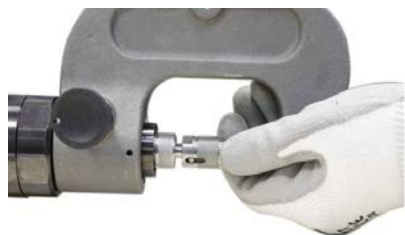
Привинтите насадку, идущую в комплекте с плечом
